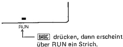
Im RUN-Modus sind die in der folgenden Abbildung gezeigten Tasten und Funktionen verwendbar (das gleiche gilt für den PRO-Modus)
